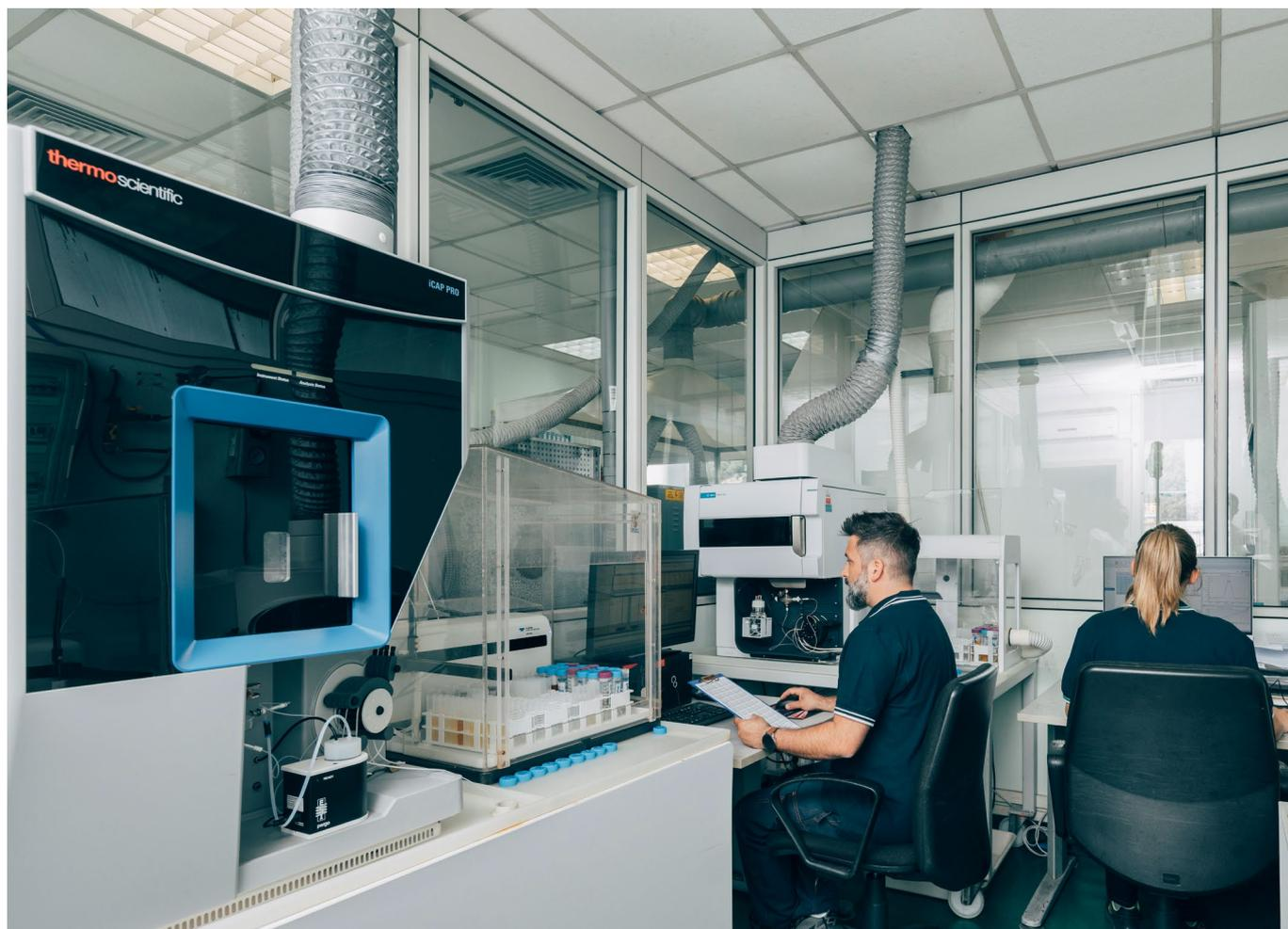
Il laboratorio chimico sceglie e applica le tecniche di analisi più adeguate al tipo di materiale per la determinazione del contenuto dei metalli preziosi. È infatti in grado di effettuare con la massima precisione sia analisi con metodo gravimetrico (coppellazione) sia analisi con metodi strumentali (ICP e XRF). La corretta combinazione di
